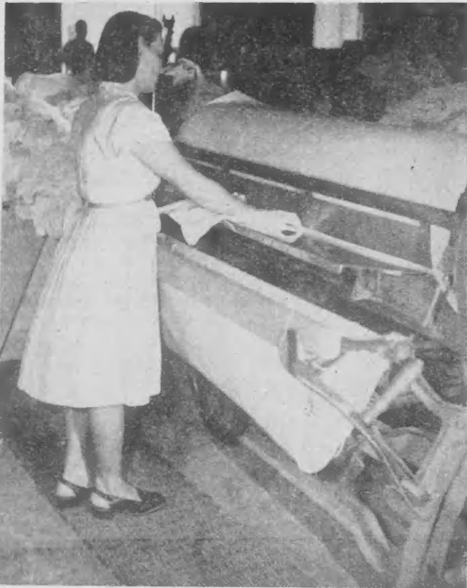
Supervisor di labamento, Paulito Arends, ta cerra porta di e machien di laba promé cu e start e machien. E empleado mester tene cuidao cu e portanan dobbel plás, pa e no hiba daño na su mannan.
